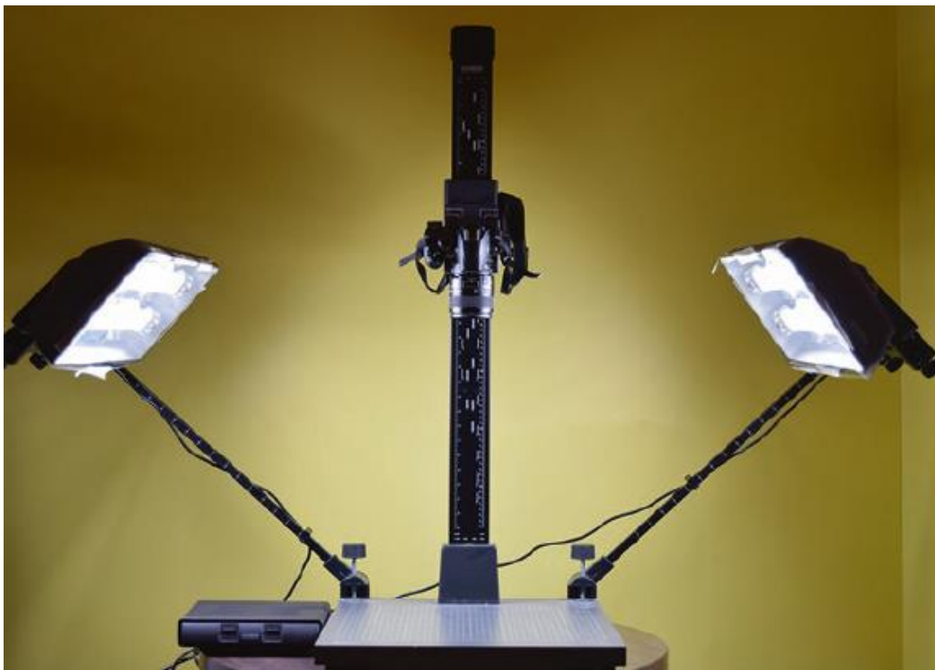
(الشكل ١٢-٣) حامل نسخ مزود بإضاءة مخصصة وكاميرا رقمية مثبتة للسماح بتصوير العناصر الفردية
